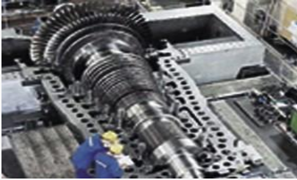
Figura 2. Turbina de vapor abierta.
