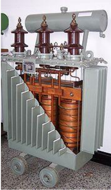
Figura 5. Interior de un transformador.
